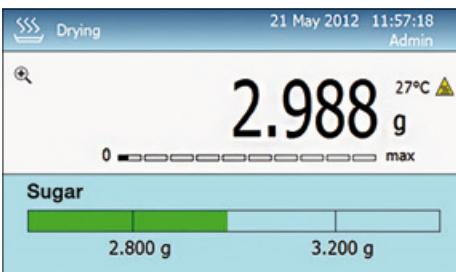
Waageninterner Speicher für den automatischen Ablauf von 300 Trocknungsprogrammen (pro Speicherplatz 12 freie Zeichen) sowie weitere 100 Speicher für durchgeföhrte Trocknungsprozesse, einzeln abrufbar
